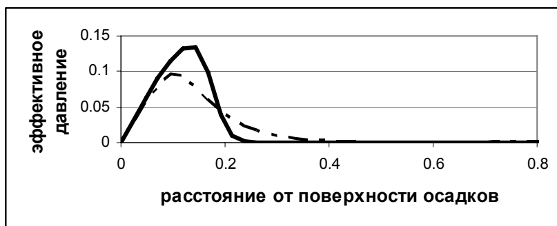
Рис. 1. Распределение эффективного давления по глубине осадков для двух различных значений механического критерия подобия D ( D = 0.002 – сплошная линия, D = 2 – пунктирная линия)
