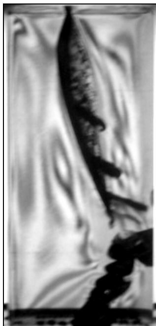
Рис. 1. a – модельный образец с возникшей генетической трещиной; б – эпюры главных напряжений по горизонтальному сечению (1-1), образец № 9
